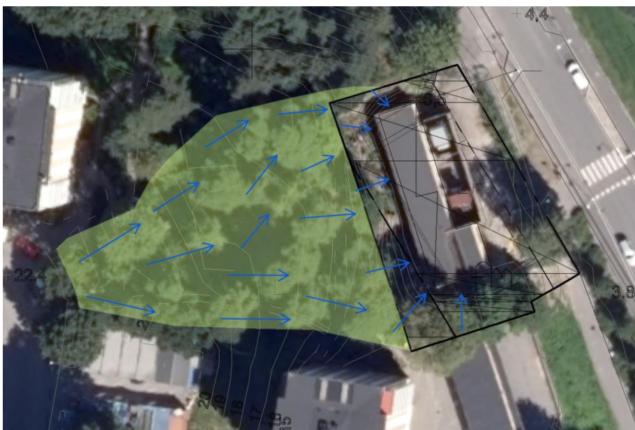
Figur 5. Planområde (svarta gränser) samt dess avrinningsområde (grönmarkerat). Pilarna visar riktning för ytavrinning. Bild skapad utifrån ortofoto och plankarta i GIS (ArcMap 10.4).
