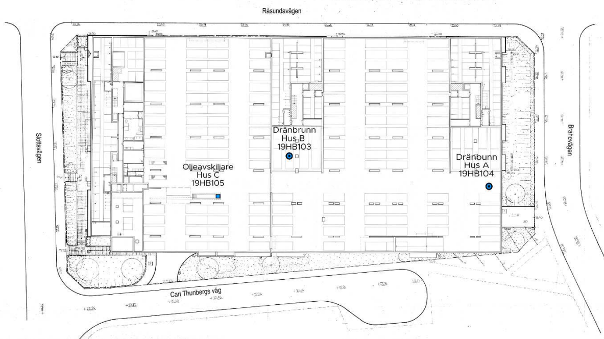
Figur 1. Provtagningspunkter för vatten i nedre källarplan inom Flundran 4.
