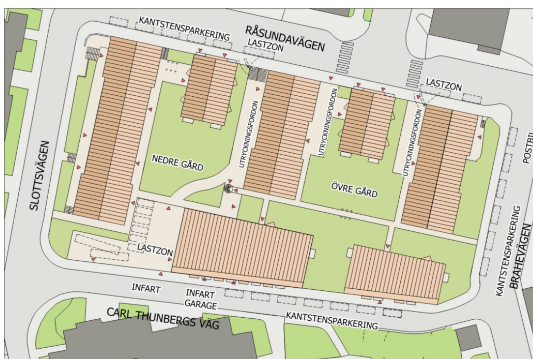
Illustrationsplan, vilken visar framtida gata, infart garage, lastzon och utrymme för utryckningsfordon (Noa)
