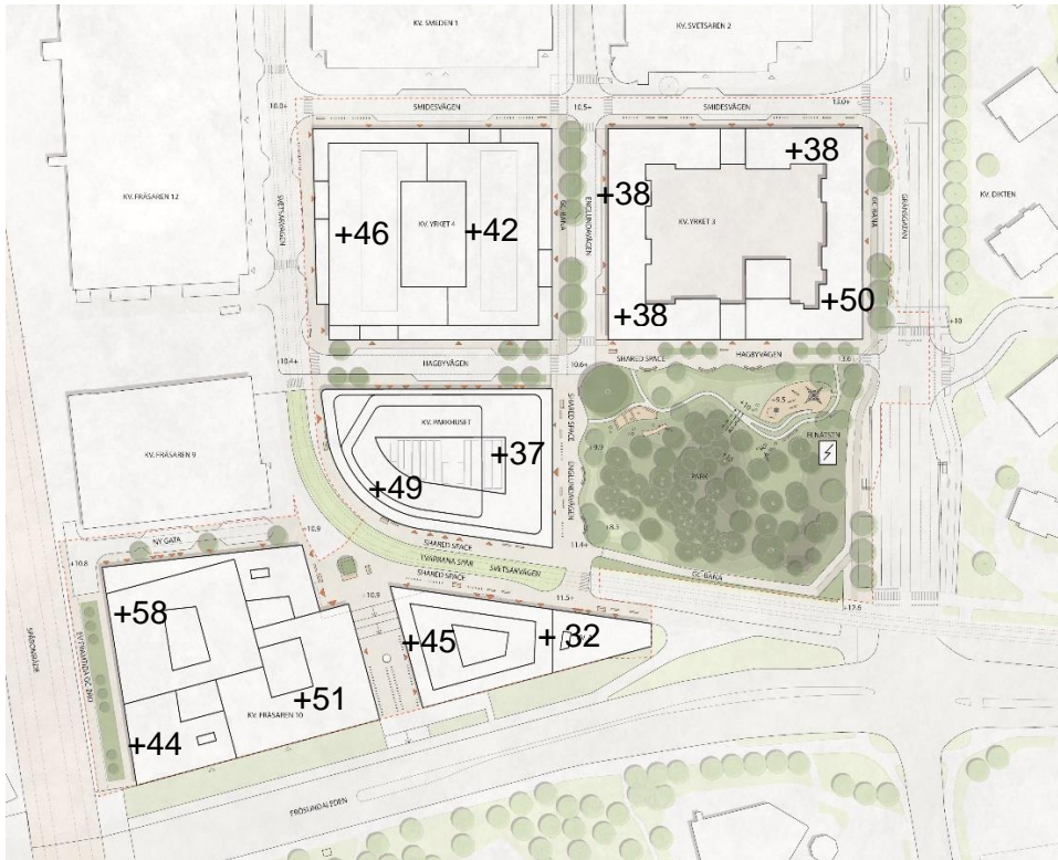
Figur 4. Planerade byggnader. Siffrorna anger ungefärliga planerade plushöjder på de större huspartierna. Gatuhöjden varierar mellan ca 10 och 15 meter.
