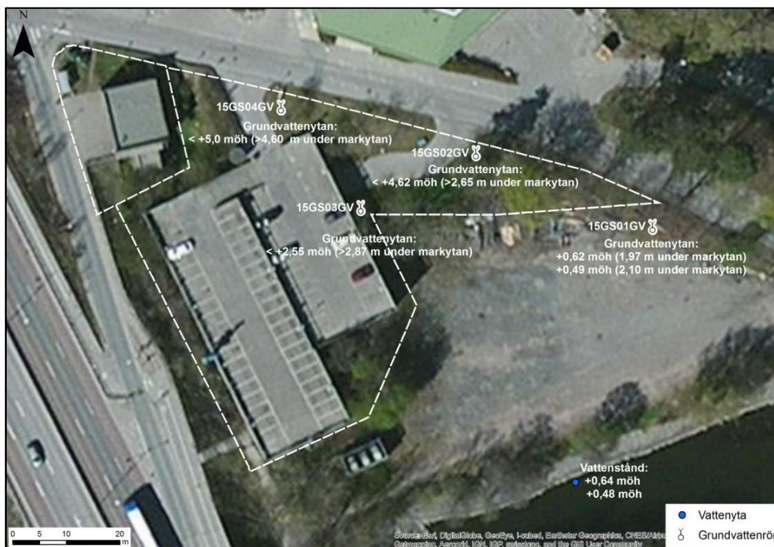
Figur 2-9. Grundvattenrör sattes i fyra olika punkter och de uppmätta värdena anges i figuren, både i meter över havet (m ö.h.) och avstånd från markytan till grundvattenytan.
