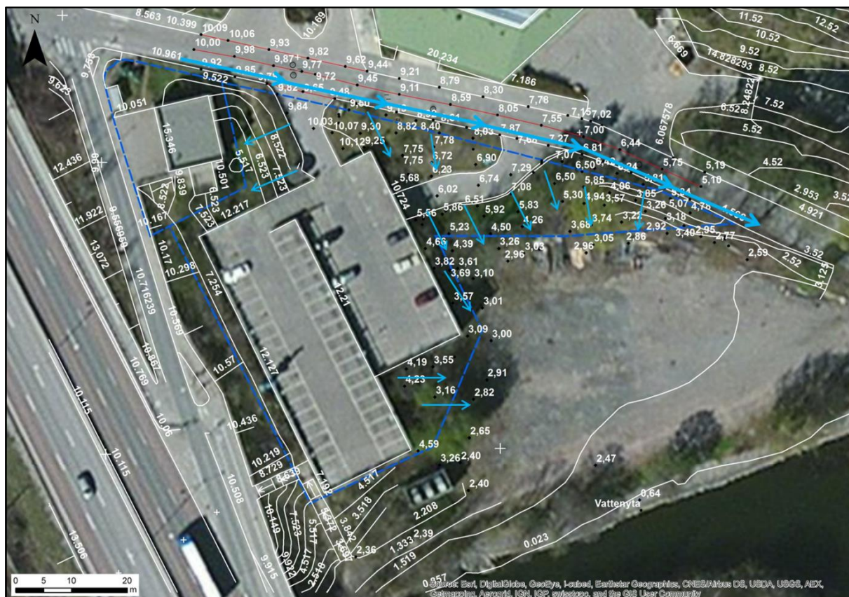
Figur 2-12. Flygfoto över undersökningsområdet med inmätta markhöjder. Flödesriktningar för avrinningen, baserad på topografien, är markerade med blå pilar.
