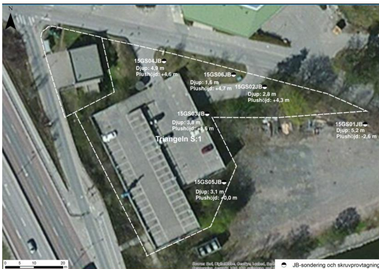
Figur 2-8. Jorddjupen ner till bedömd bergnivå redovisas från markytan. Bergnivåerna redovisas som plushöjder.
