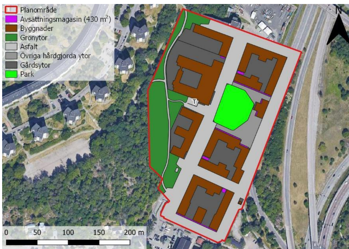
Figur 21. Planerad placering och utbredning av dagvattenmagasin (av typ avsättningsmagasin) inom detaljplaneområdet. "T" markerar stationsentrén till tunnelbanan. Utbredning magasin och övriga ytor: Urbio (2022-04-25). Bakgrundskarta: Google Satellite (u.å.).
