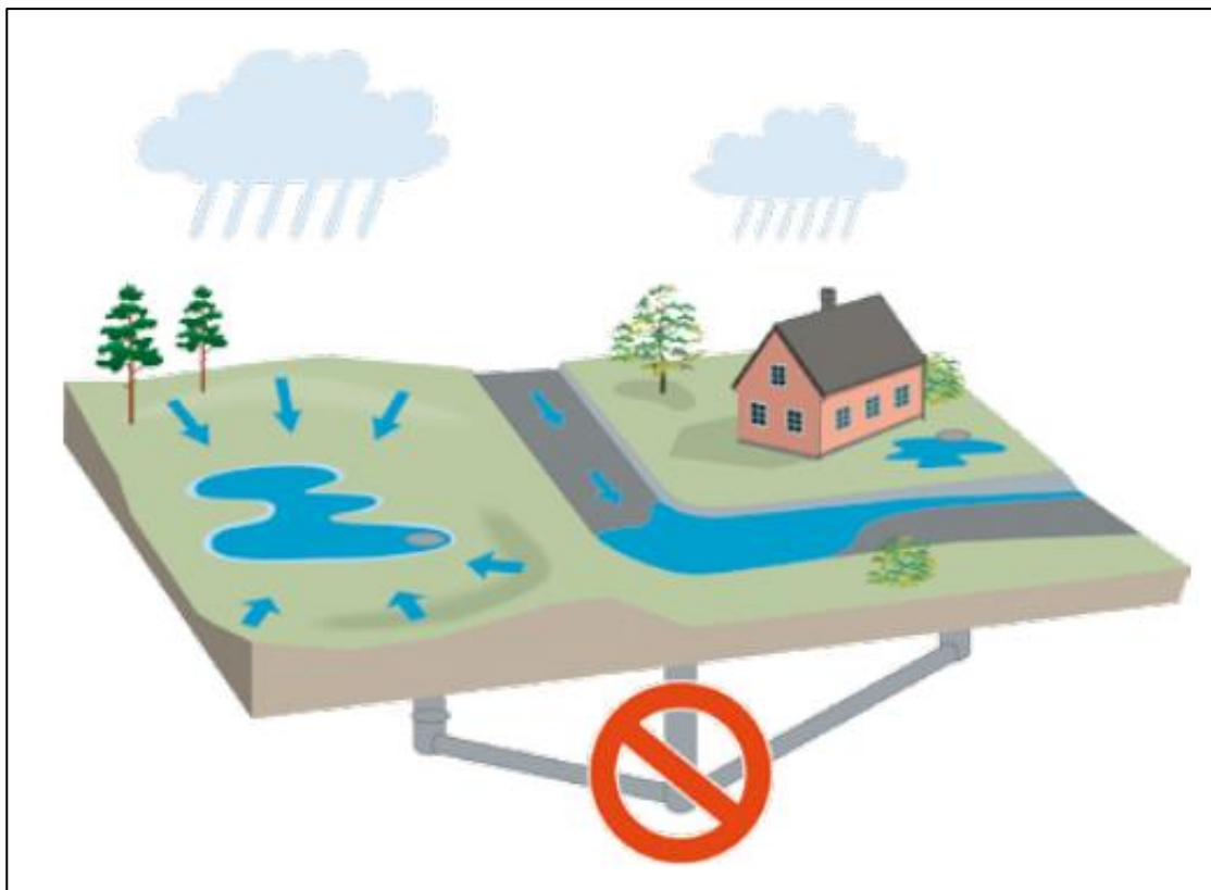
Figur 2-1 Illustration av principen för skartering av markavrinning där ingen dynamisk koppling görs till ledningsnätet utan ledningsnätets kapacitet representeras av ett schablonmässigt avdrag från det regn som appliceras på hårdgjorda ytor i modellen (MSB, 2017).
