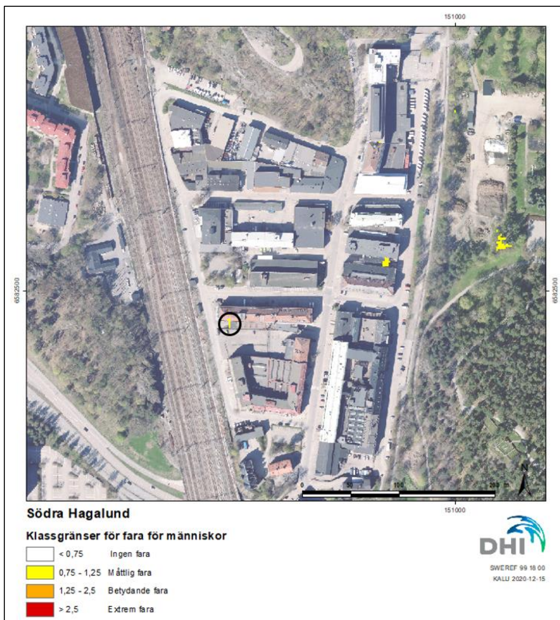
Figur 3-3 Beräknad fara för människor inom Södra Hagalunds arbetsplatsområde med hänsyn till maximal flödes hastighet och maximalt flödesdjup. Identifierad risk intill den västra garagedfarten inringad. Beräkningen baseras på befintlig höjdsättning och utformning av området. Planerad exploatering bedöms inte förvärra situationen med hänsyn till risk för fara för människor.
