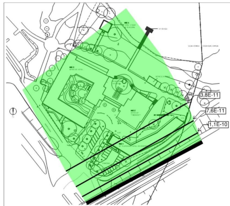
Figur 26. Individrisk Prognosåret 2040, utan åtgärder. Grön markering visar var individrisken är acceptabel. (Brandkonsulten, 2020).
