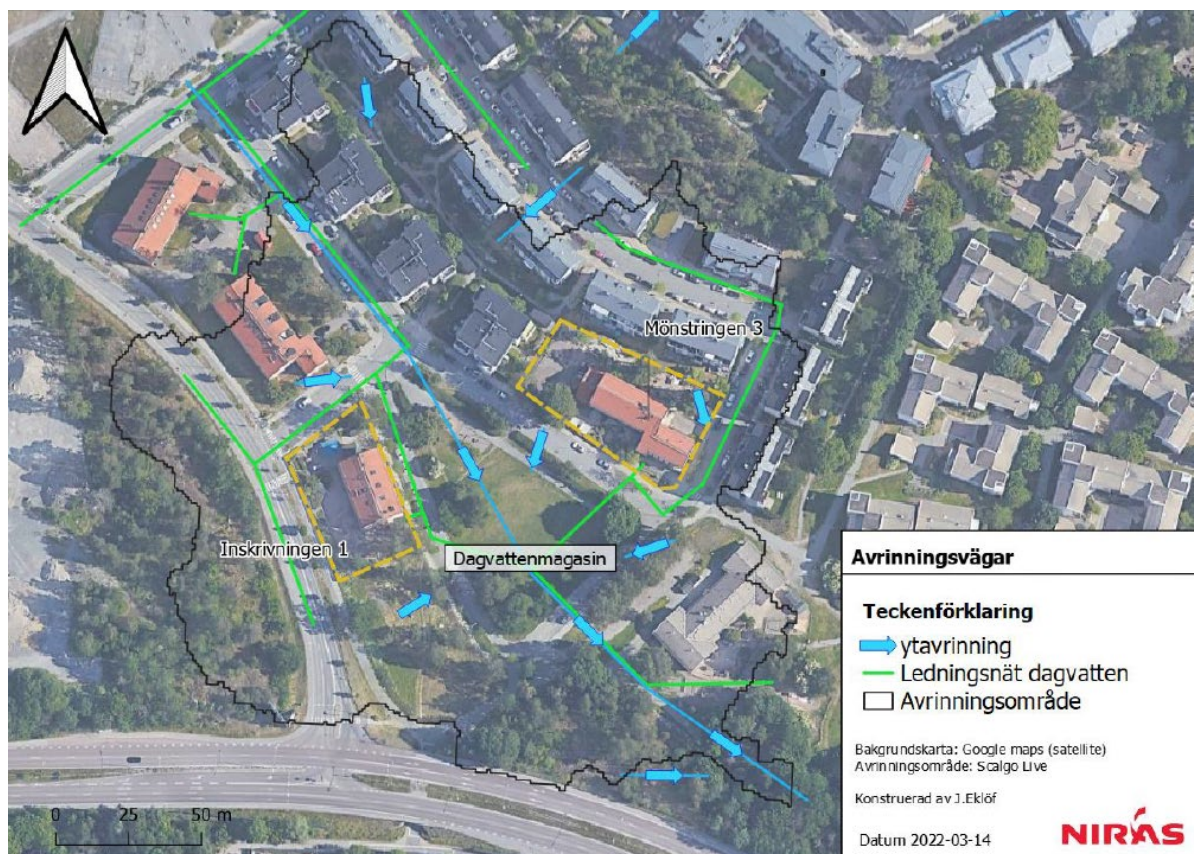
Dagvattennätet och ytlig avrinning inom avrinningsområdet för fastigheterna. Det huvudsakliga flödet går längs den blå linjen från väst till sydöst, bild Nirás.
