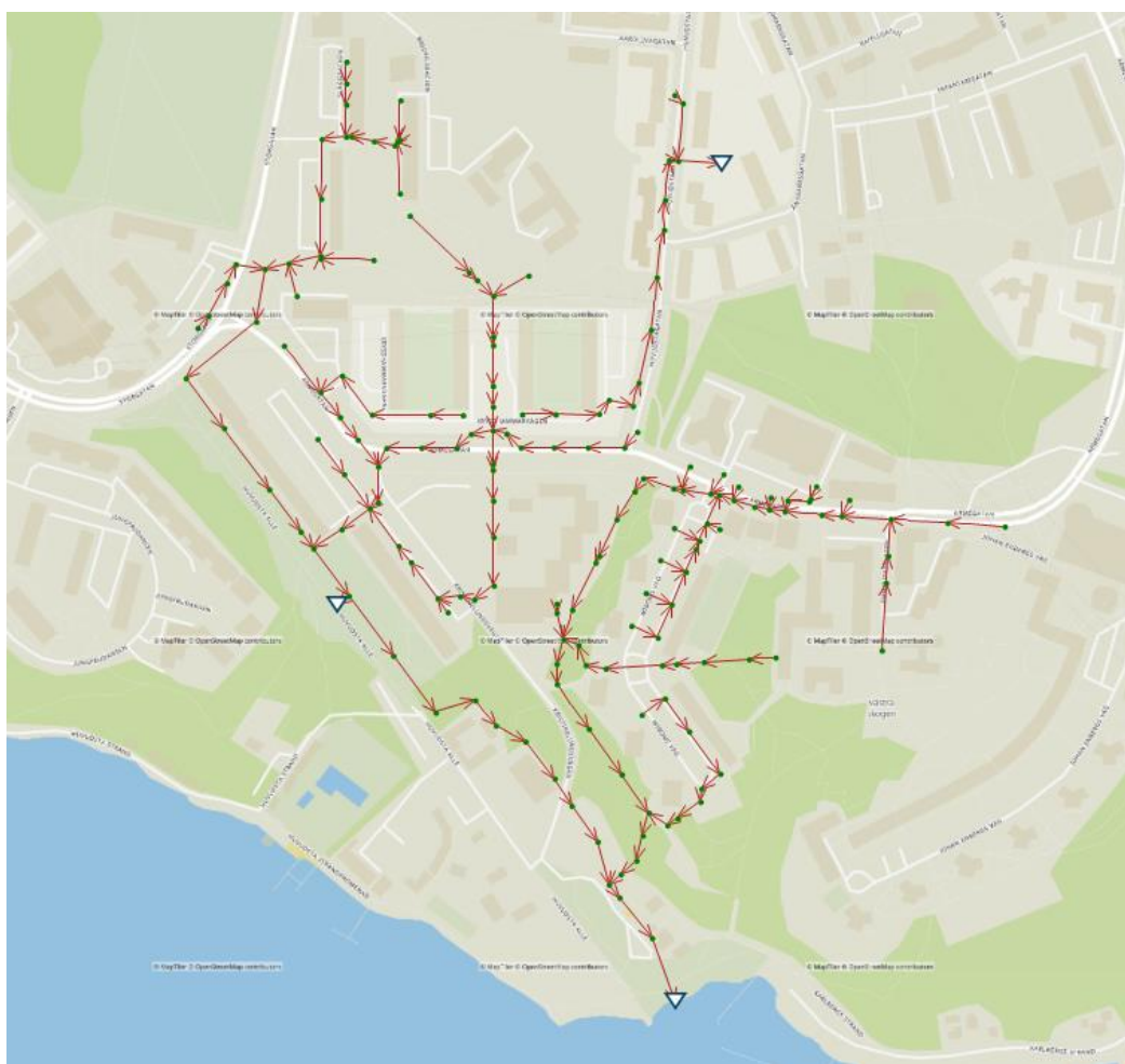
Figur 2-5. Beskrivning i MIKE+ av det framtida dagvattenledningsnätet.
