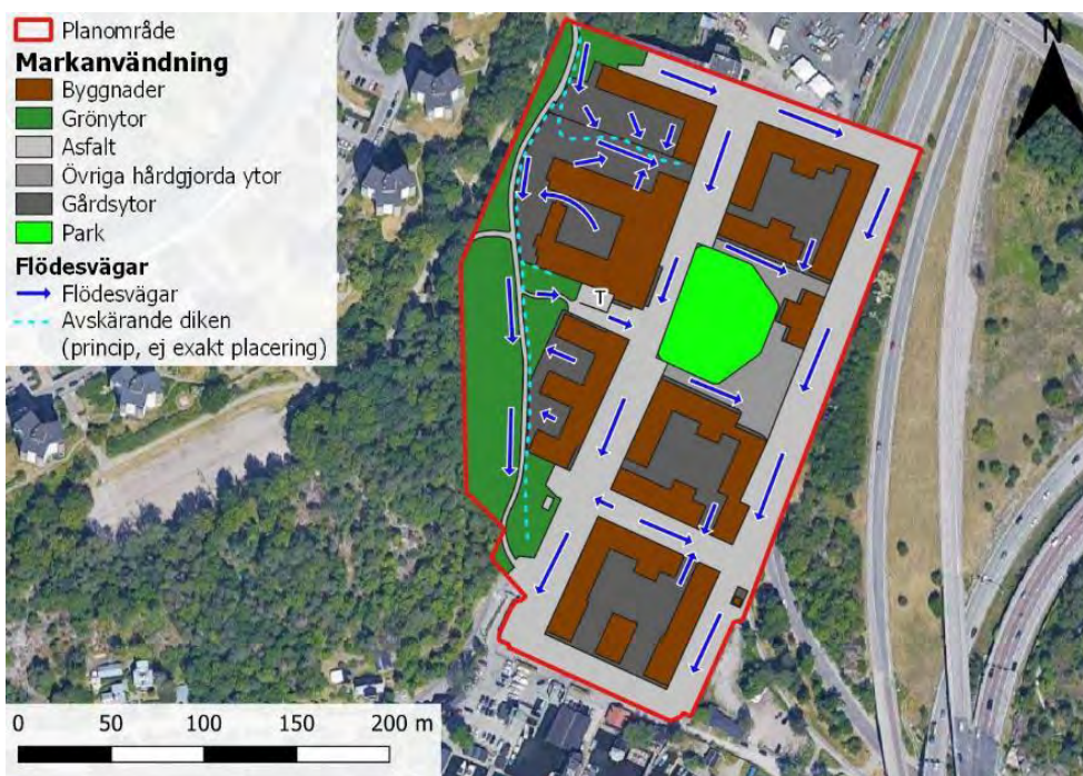
Framtida flödesvägar för dagvatten ovan mark.
