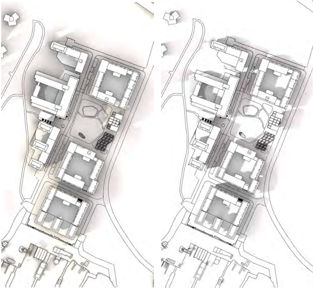
Skuggning vid vårdagjämning (20 mars) kl 16 samt skuggning vid sommarsolstånd (21 juni) kl 16. Kjellander Sjöberg.
