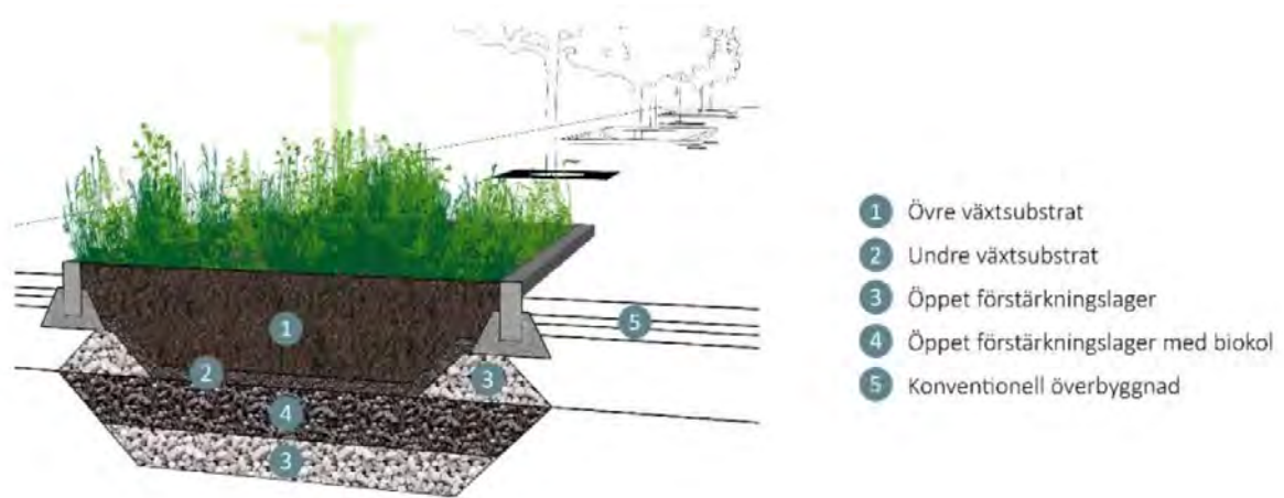
Figur 18. Principiell sektionsskiss av träd i skelettjord i öppet täcklager.
