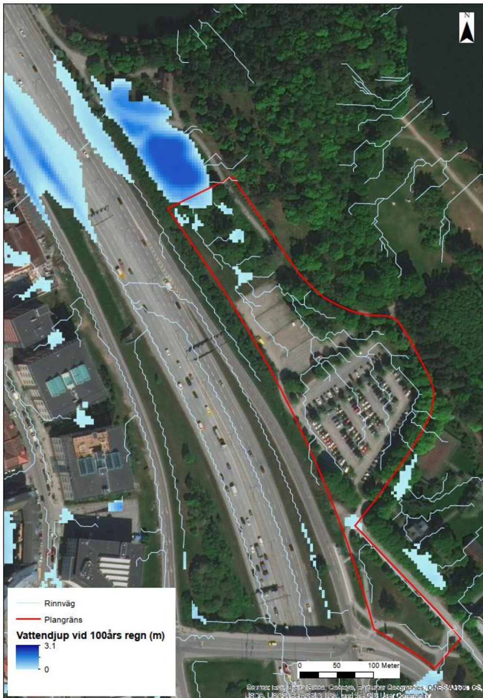
Figur 14. Rinnvägar och översvämningsytor vid ett 100-årsregn (55 mm regn) modellerat i Scalgo utifrån nuvarande topografi och utan hänsyn till infiltration eller annan avrinning. (© ESRI). Bakgrundsbilden visar dagens utformningen av området.
