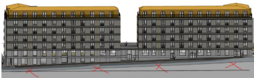
Figur 8. Planerad exploatering inom Kv. Turkosen 1. De nya flerbostadshusen är planerade längs med Huvudstagatan i väst och har en innergård mellan sig och den befintliga byggnaden inom fastigheten. Illustrationen visar fasad mot Huvudstagatan och de röda kryssen visar ungefärlig planerad placering av stuprör (Illustration från White, 2022-01-10).
