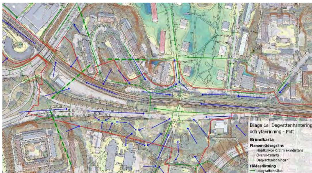
Fig 60. Nuvarande ytvavrinning och dagvattenhantering i den mellersta delen av planområdet (WRS)
