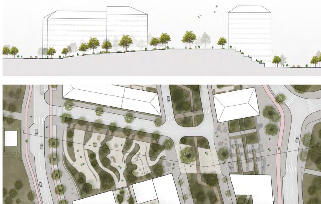
Figur 32. Plan och sektion genom sluttande parken, snitt i syd-nordlig riktning
