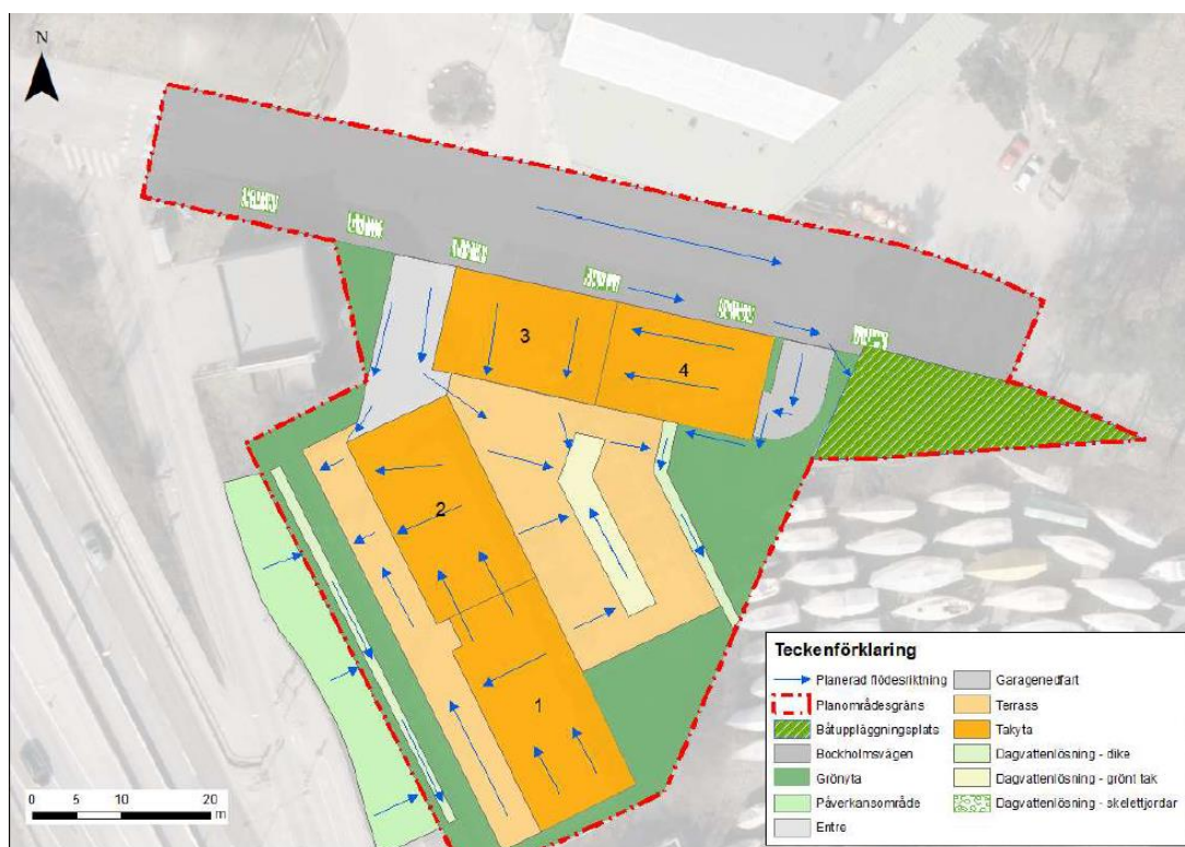
Figur 11. Föreslagna placeringar av dagvattenlösningar. Planerade flödesriktningar för avrinning från tak och terrass markeras med pilar.
