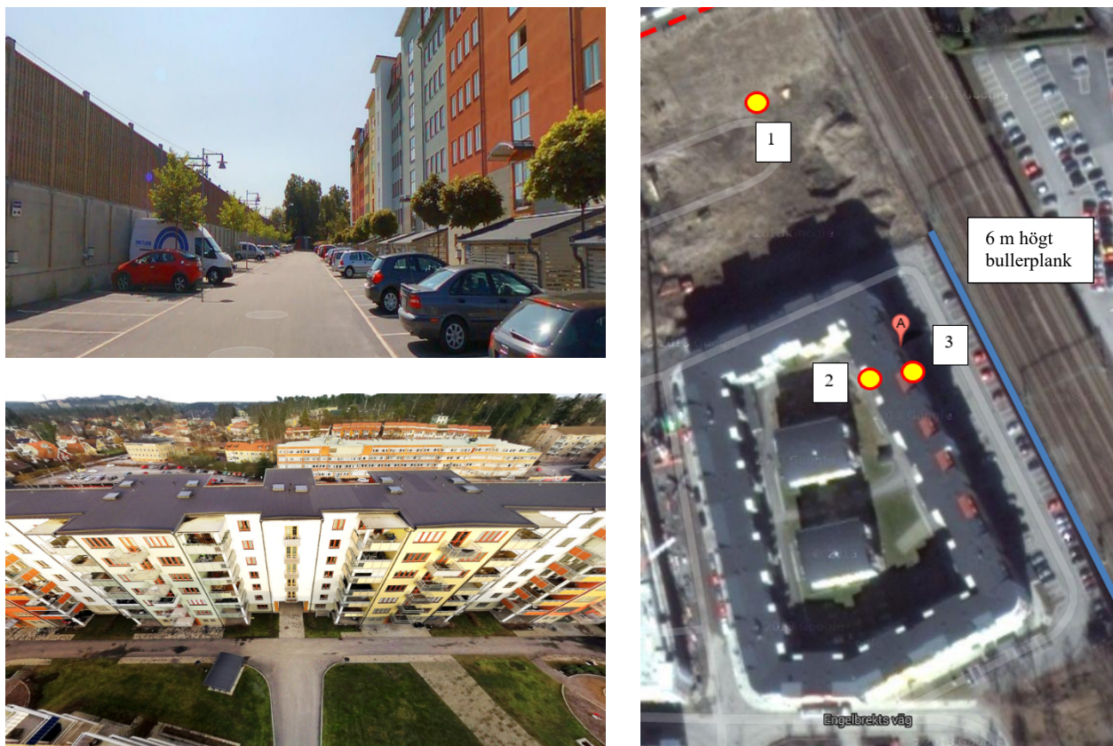
Figur 4) Mätpositioner (2 och 3) dikt an befintlig fastighet inom kv Traversen 7. Frifältsmätning skedde även i mätposition 1, dock inte samtidigt.
